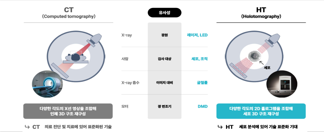
[그림 57] 홀로토모그래피(HT) 개념 및 CT 비교
