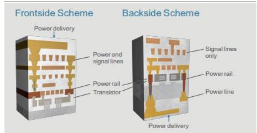
그림 01. Backside Power Delivery Network(BSPDN) 구조 모식도
